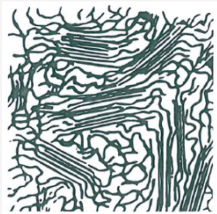
Estrutura molecular dos plásticos semi-cristalinos: moléculas sólidas têm uma estrutura parcialmente cristalina
